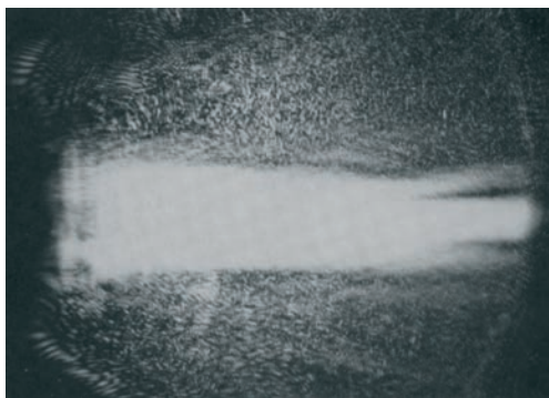
Рис. 1.10 Фотография волнового поля в воде. Эта методика (регистрация мелких колебаний среды) позволяет непосредственно увидеть области высокого давления ультразвука. Ультразвуковой датчик находится слева. Хорошо видно формирование двух боковых лепестков (из 11).
